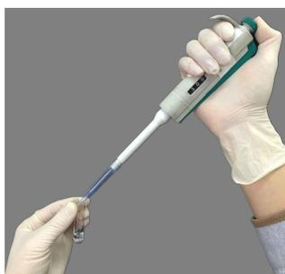
2. 吸取 4ul 的血清样本加入到预装试剂的反应杯中
