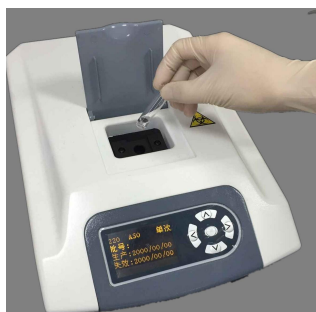
2.先吸取血清/血浆样本 25ul 加入到预装试剂的反应杯中
