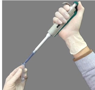
2.先吸取血清/血浆样本 25ul 加入到预装试剂的反应杯中
