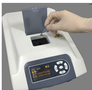
4. 放入仪器检测孔，按 下中间测试键
